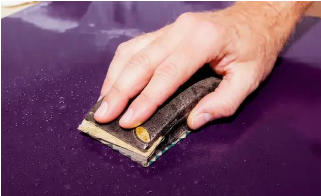
Ponçage à l'eau avec un bloc de ponçage.
