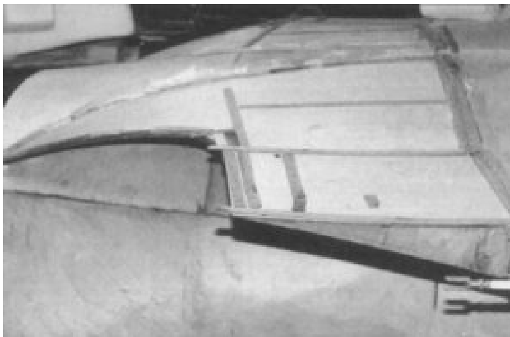
Photo 1 : Il s'agit d'un fuselage (à l'envers) montrant l'ajustement complexe des revêtements en contreplaqué à la jonction du fuselage et des carénages d'emplanture d'aile.
