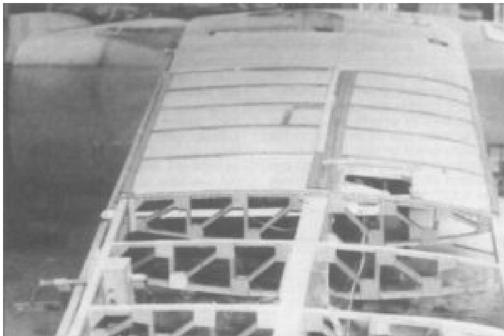
Photo 2 : L'intrados d'une aile est en cours de revêtement. Remarquez qu'il est nécessaire d'utiliser trois ou quatre bandes de clouage côte à côte pour serrer le long du longeron large. N'oubliez pas le joint en sifflet d'extrémité pour le prochain revêtement en contreplaqué.
