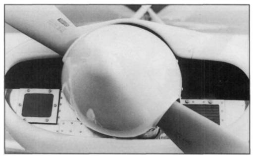
Une capot moteur avec une seule grande ouverture n'est pas optimal ni matière de refroidissement du moteur ni de réduction de la traînée.
