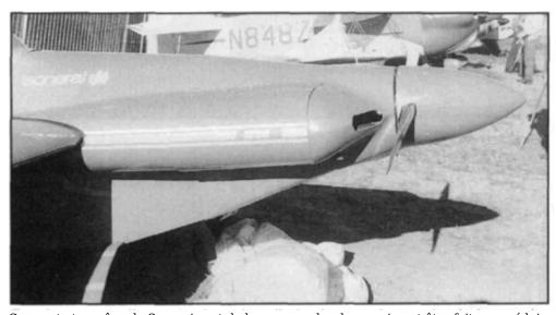
Ce capot et ce cône de Sonerai sont de bons exemples de ce qui peut être fait pour réduire la traînée globale. Remarquez la taille minuscule de l'ouverture d'entrée d'air. Comparez cela à la photo montrant une seule grande ouverture d'entrée d'air..
