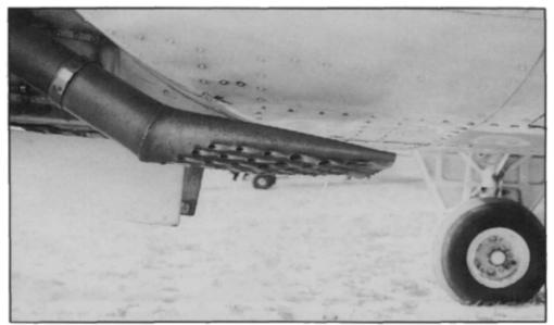
Cela peut-il représenter l'optimum en matière de sorties d'échappement à faible traînée?
