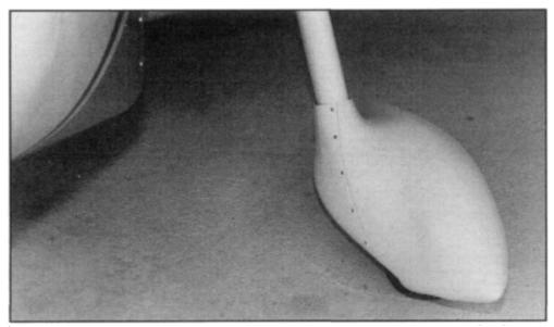
À l'intérieur de ces carénages de roues se trouvent des parties à forte traînée et l'intersection entre l'essieu et le bras de suspension. Résultat : une traînée réduite et une apparence améliorée.
