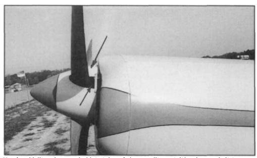
Un cône d'hélice plus grand réduirait la traînée et améliorerait l'écoulement de l'air vers les prises du capot.
