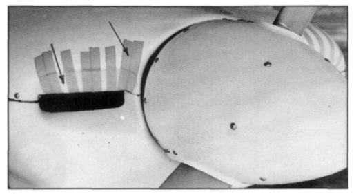
Réduire la taille des prises d'air peut permettre d'obtenir une augmentation significative de la vitesse.
