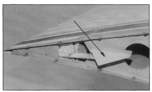
Les masses d'équilibrage des ailerons immergées ne créent aucune traînée. L'extrémité de l'aile en fibre de verre a été retirée pour montrer une façon d'atteindre l'équilibrage des ailerons.
