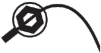
Le blocage mécanique utilise une barrière physique visant à empêcher l'élément de fixation de tourner.
