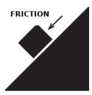
Les méthodes de blocage par friction reposent sur la prévention du glissement des surfaces l'une contre l'autre en augmentant la résistance (friction) entre ces surfaces de contact. L'augmentation de la friction entre les filets mâles et femelles, ou entre l'élément de fixation et la surface de contact, crée une résistance au desserrage.
