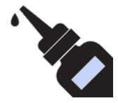
Cette méthode utilise un liquide, appelé adhésif de blocage des filetages, pour empêcher un assemblage boulonné de se desserrer. L'adhésif est appliqué sur le filetage de l'élément de fixation.
