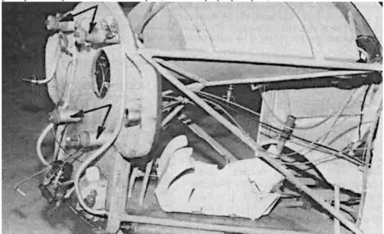
L'installation d'un moteur VW sur un Sonerai est simple comparée à celle d'un moteur Lycoming monté sur support dynafocal dans un avion équipé d'une hélice à pas variable et d'un train d'atterrissage tricycle escamotable. Remarquez le support moteur court de type « stand-off » avec ses amortisseurs en caoutchouc coniques.
