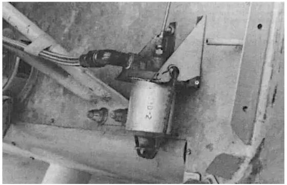
Choisir un emplacement approprié pour le gascolateur est souvent difficile. Il doit être positionné de manière à constituer le point le plus bas du circuit de carburant. Le robinet de vidange rapide doit également être accessible depuis l'extérieur du capot moteur.
