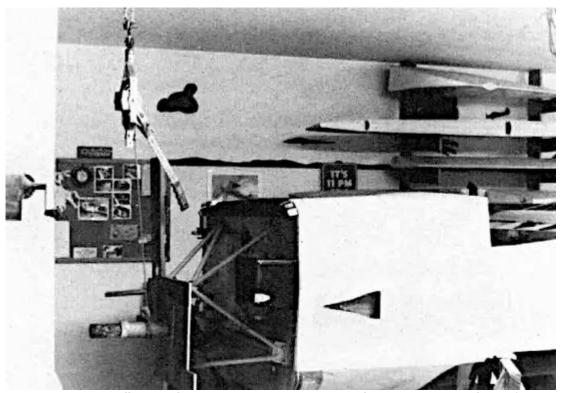
Pourquoi ne pas installer un palan pour moteur et construire quelques supports pour les surfaces de contrôle pendant que vous attendez l'arrivée de vos plans ?
