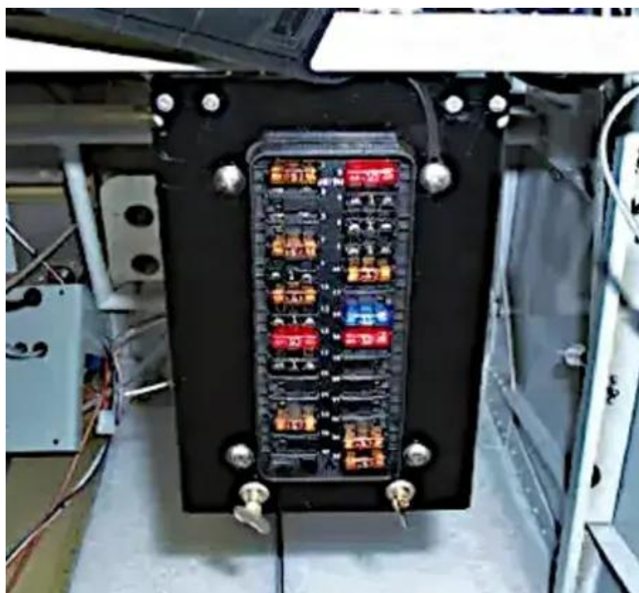
La face avant d'un panneau de fusibles avec le couvercle retiré.
