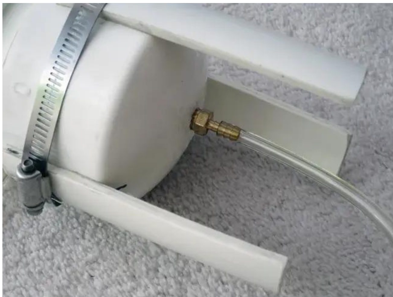
Raccord en laiton cannelé installé dans le fond du purgeur. Attaché au raccord se trouve un tube Tygon de 1/4".
