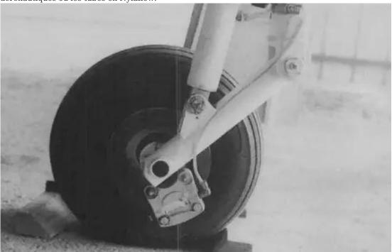
L'ensemble de ce système de freinage est constitué de tuyaux en Nylaflow, souples et faciles à acheminer, utilisant des raccords et connecteurs à compression de type automobile.
