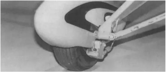
Les étriers de freins dépassant sous les essieux, comme installés sur cet avion, peuvent être endommagés ou complètement détruits en cas de crevaison ou d'éclatement de pneu lors du décollage ou de l'atterrissage.
