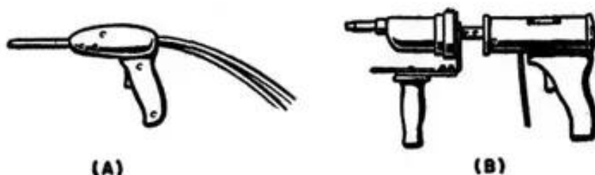
Fig. 110.— Riveuses thermiques, servant à poser les rivets explosifs.
