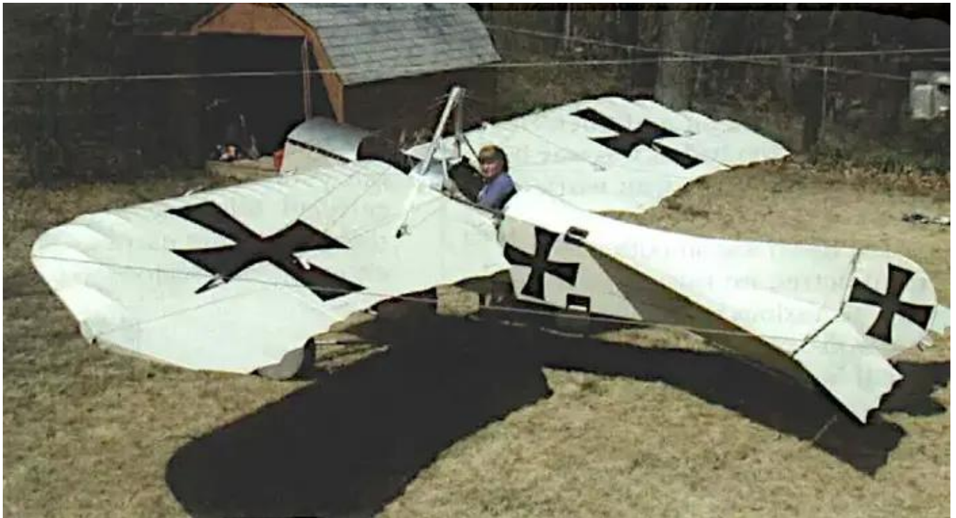
Sur ce Taube, toutes les tôles et les surfaces de queue furent peintes avec la technique de « Rolling et Tipping »
