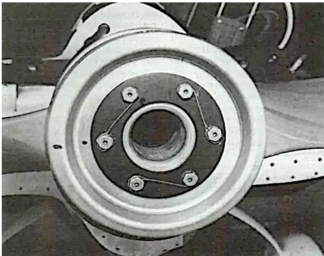
FIGURE 2 Hélice correctement installée où les boulons sont freinés deux par deux.
