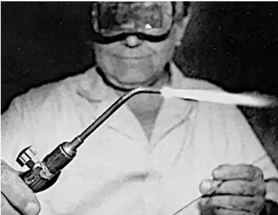
La torche de soudage Airline est la torche de taille idéale pour le soudage d'aéronefs.
