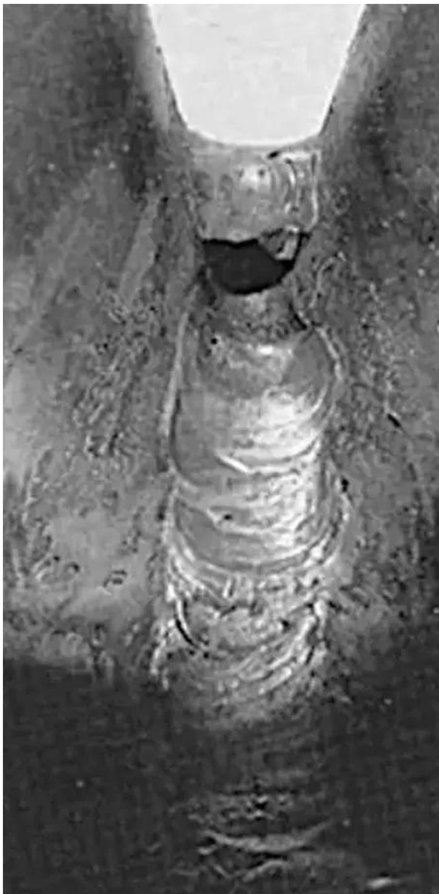
Ce gros plan d'un joint en « V » montre comment un bain de fusion peut se fondre au-dessus du bord du matériau en laissant un léger vide à un endroit.
