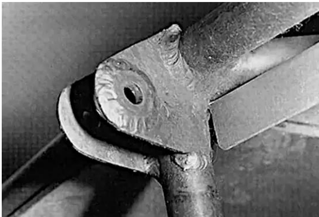
Une fixation d'aile typique montrée ici présente des soudures d'excellente qualité.
