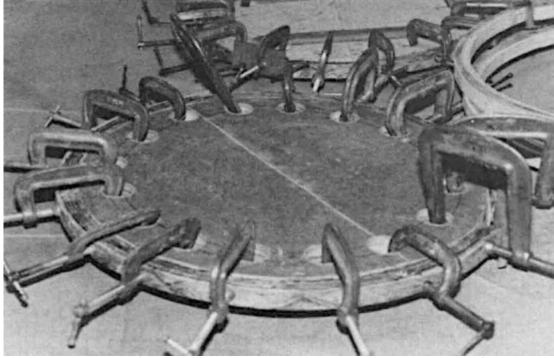
Un puits de roue stratifié est facile à fabriquer dans ce type de gabarit en contreplaqué. Percez de grands trous à environ un pouce du bord pour permettre l'accès aux serre-joints, comme indiqué. Il
