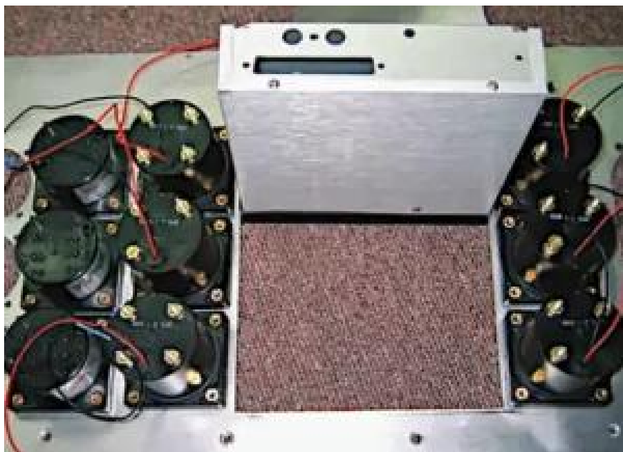
Photo 2. Ce constructeur n'a pas laissé suffisamment d'espace entre les instruments ronds et la découpe destinée à la pile radio.
