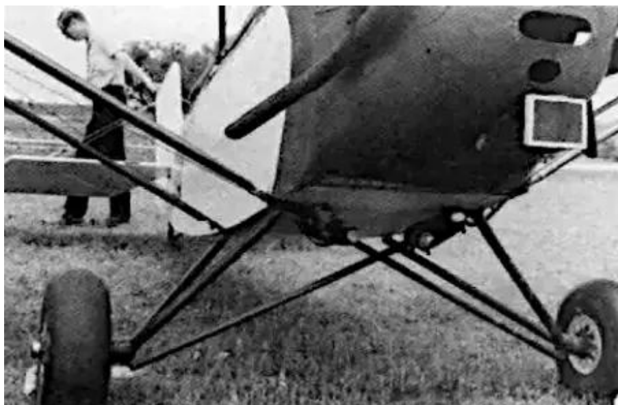
Une variante de l'ancien train d'atterrissage du J-3 Cub, complète par des sandows pendants exposés au flux d'air.
