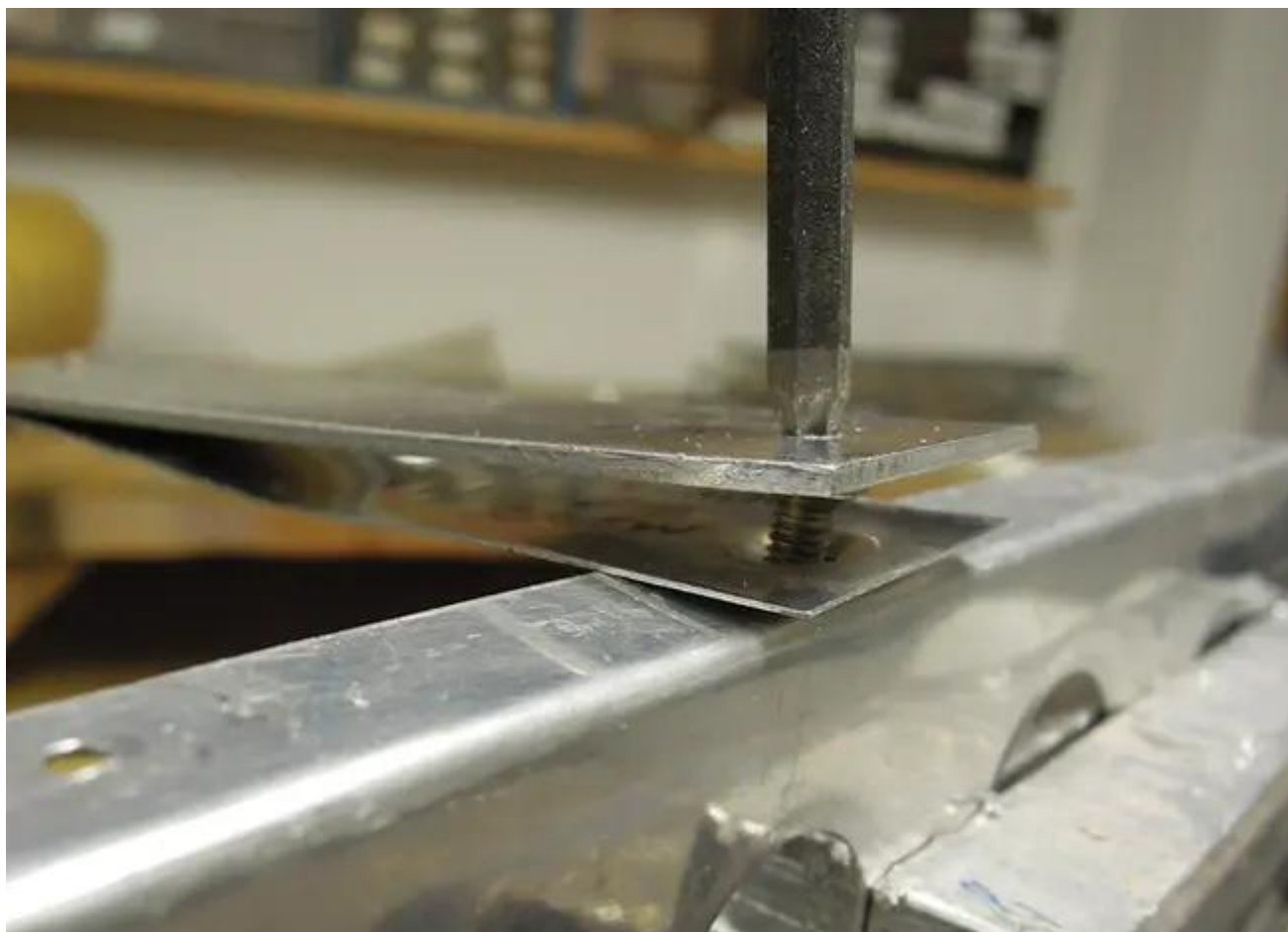
Une vis Torx fixe la lame mince du localisateur de trou à l'écrou prisonnier.
