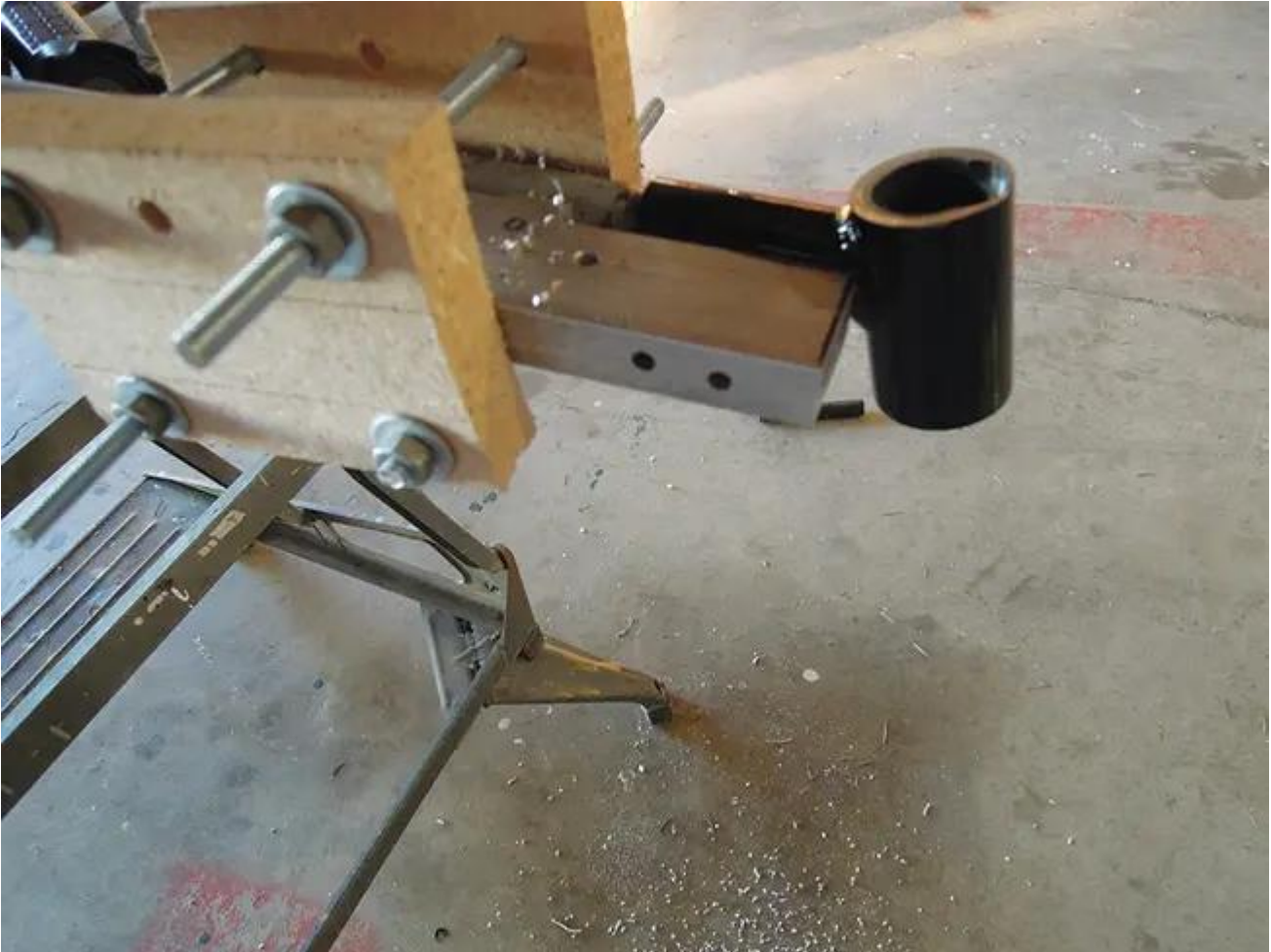
Le gabarit est serré sur le ressort de queue. Des trous ont été percés dans le gabarit, en utilisant le ressort comme guide.
