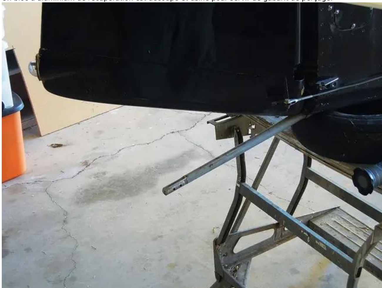
Le ressort de queue, avec les trous existants qui doivent être reproduits.
