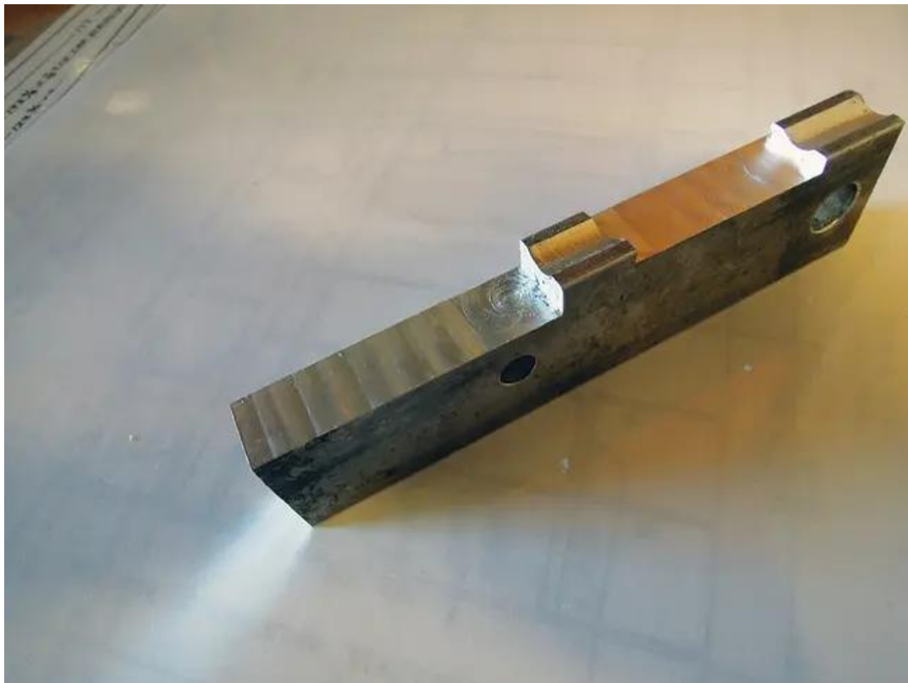
Un bloc d'aluminium de récupération est découpé et usiné pour servir de gabarit de perçage.
