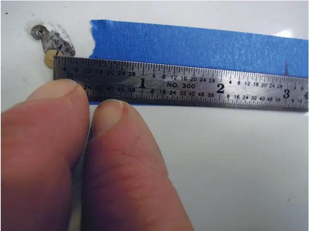
Une ligne et une distance localisent le centre d'un trou.
