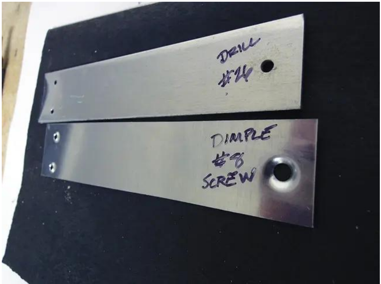
Le trou le plus grand est embouti pour une vis n° 8.
