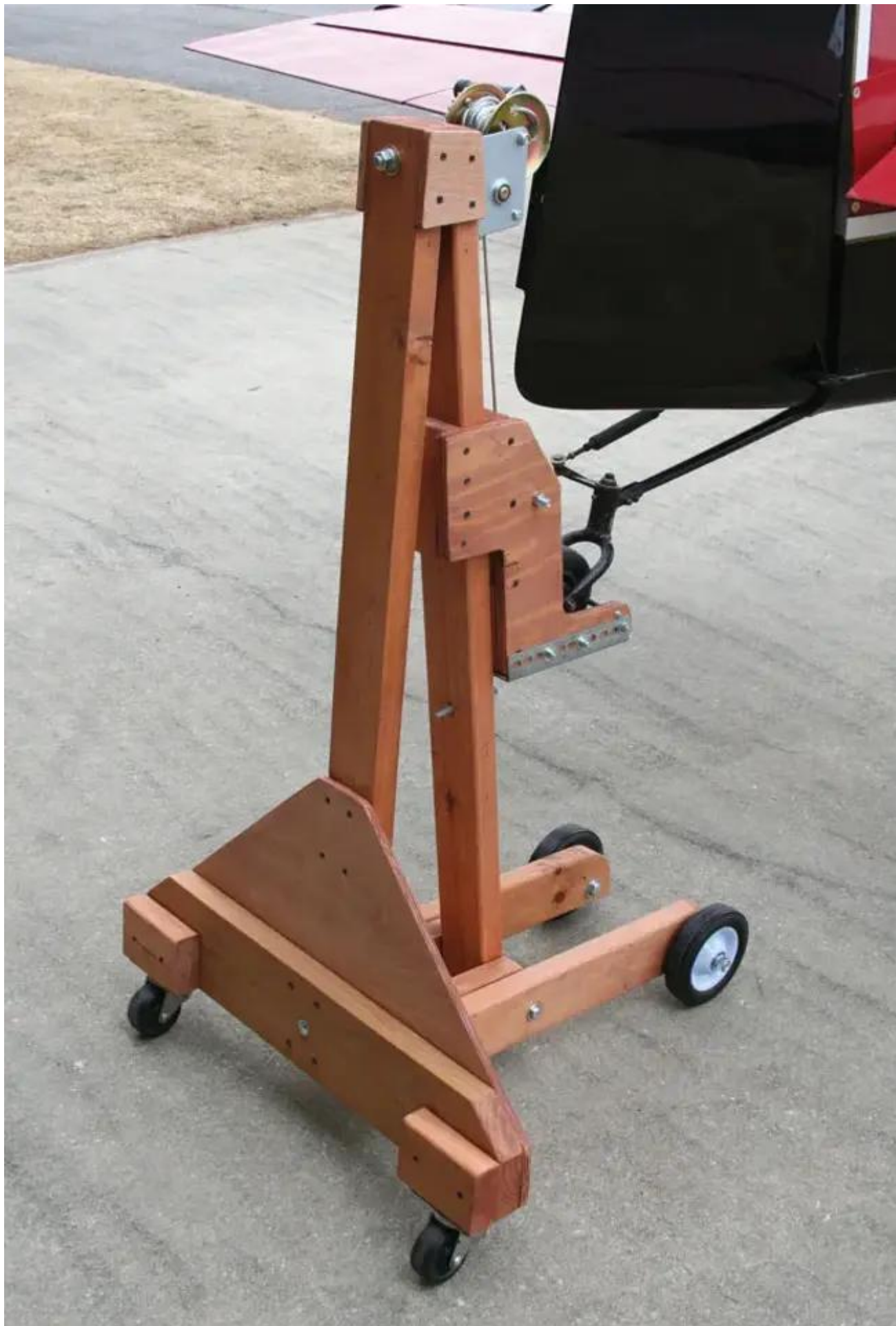
Le montant arrière est renforcé avec du contreplaqué de 1/4", ce qui donne une conception très robuste. On voit également la sécurité à anneau à œil insérée dans la rampe.
