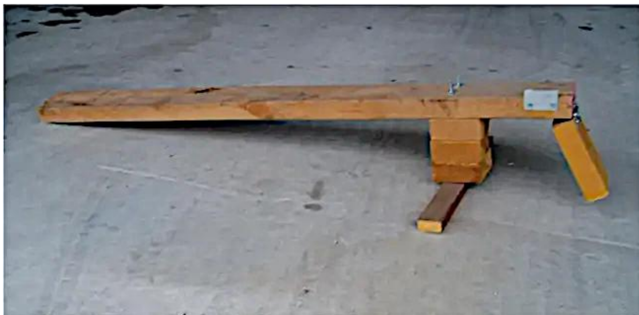
Le cric terminé et prêt à l'emploi.
