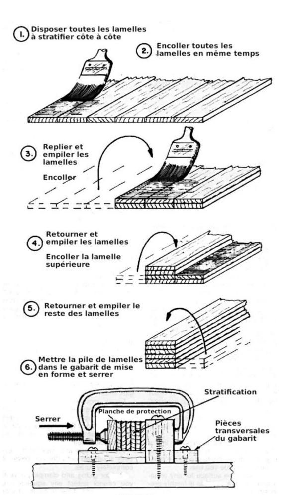
FIGURE 3 accélérer l'encollage des lamellés-collés
