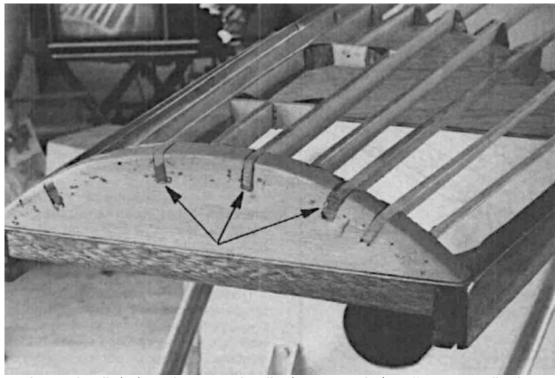
L'utilisation de colle à résine plastique ou de colle résorcine est plutôt inefficace pour coller des lisses dans des encoches comme montré ici. Des joints meilleurs et plus solides seraient obtenus avec une colle à remplissage des interstices comme l'Aerolite ou l'époxy T-88.
