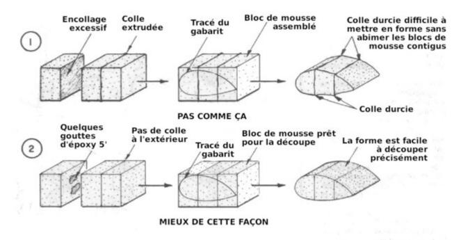
FIGURE 2 Assemblage de blocs de mousse pour gabarits
