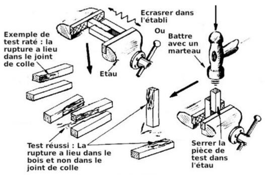
FIGURE 1 Eprouvettes pour test de collage en cisaillement
