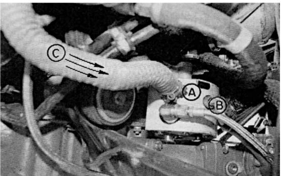
En enfermant la pompe à carburant entraînée par le moteur dans un simple bouclier en aluminium, on contribue également à réduire les problèmes de vapeur de carburant dans le système. L'air de
