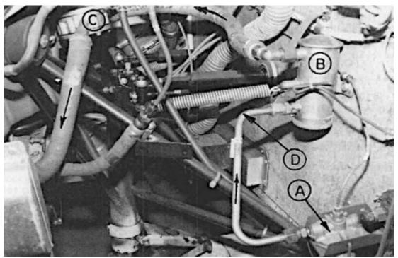
Dans cette installation, la pompe à carburant électrique (B) est située en aval, entre le décanteur (A) et la pompe entraînée par le moteur (C). L'utilisation d'une conduite en aluminium (D), comme illustré, est correcte, les deux unités étant solidement fixées à la cloison pare-feu.
