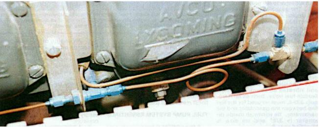
Cette installation de tubulure de purge est correctement fabriquée et bien fixée, bien que les supports pourraient être plus petits et plus légers. Remarquez la boucle classique de 2" dans les conduites en cuivre de 1/8" pour absorber les vibrations et prolonger la durée de vie du tuyau.
