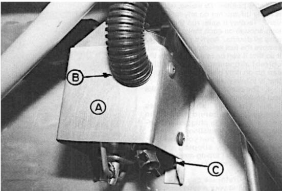
Ce décanteur est protégé de la chaleur du moteur par un simple couvercle en aluminium (A) dans lequel de l'air frais provenant du déflecteur arrière du moteur est dirigé par la conduite (B). La vanne de vidange rapide (C) est plus utile si elle est accessible depuis l'extérieur sans avoir à retirer le capot.
