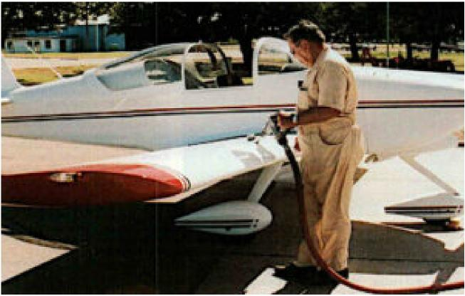
Si vous laissez quelqu'un d'autre ravitailler votre avion, il serait prudent de vérifier visuellement le niveau de carburant et de remettre vous-même le bouchon de carburant.
