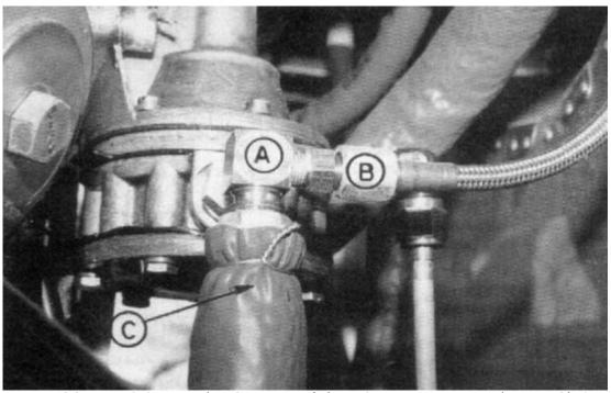
Le raccord de sortie de la pompe à carburant entraînée par le moteur (A) est percé et taraudé afin de fournir une source pour la conduite de pression de carburant (B). Notez comment les extrémités de la gaine pare-feu (C) entourant la conduite de sortie de carburant sont fixées.
